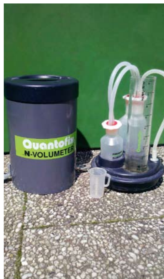
Schnelltest: Wasserlösliches Ammonium-N lässt sich mit dem Quantofix N-Volumeter einfach bestimmen.
